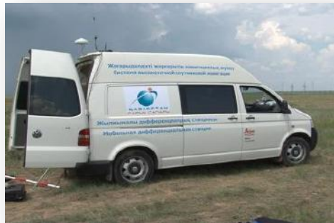
Мобильная дифференциальная станция (МДС)
